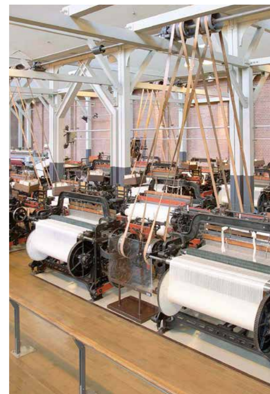
佐吉の発明による「G型自動織機」の集団運転。 いっせいに布が織られる様子は迫力満点だ。
